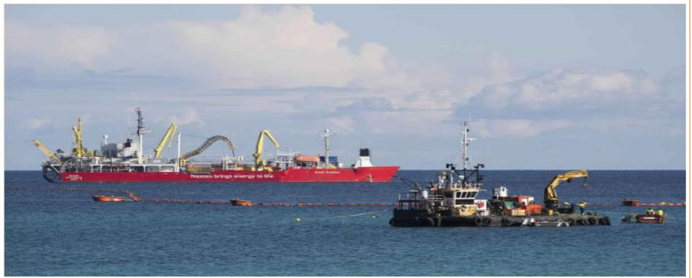
En 18 meses, Red Eléctrica de España **ha completado las diversas fases de ejecución del proyecto**, desde las gestiones previas de licitación, adjudicación e instalación del cable hasta la ejecución del tendido submarino y de las labores posteriores de protección del enlace a través de su soterramiento en el lecho marino, para maximizar la integridad y seguridad de la instalación.
